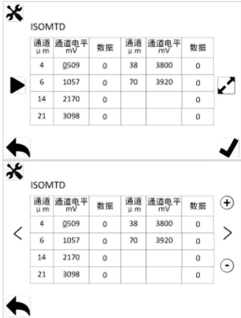
将标准物质以固定流速通过颗粒计数器，按动“
